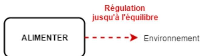
Figure 19 : chaîne fonctionnelle d'énergie avec un mode de transfert régulé par l'environnement
